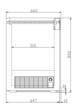
冷蔵ストッカー 形式名 SH-R360 総内容積 [ 358 |有効内容積| [\_ 外気温30℃無負荷直射日光を受けない状態に於いて 庫内温度 5 ± 3℃ 外形寸法 |mm |幅 1111 × 奥行 662 × 高さ 893 内箱寸法 mm 幅 960 × 奥行 515 × 高さ 753 製品質量 kg 59 箱 塗装鋼板 箱 塗装鋼板 断 熱 材 硬質ポリウレタンフォーム一体発泡 貯 ショーウィンドウ 棚 庫 カウンターテーブル 扉 (引戸) 上面蝶番1枚扉 明 10 W 庫内灯 源 100V 50/60Hz 電源プラグ形状 ⑪ (125V,7A) 電動圧縮機 | 全密閉形 呼称出力 100W ☆ 蒸 発 器 内箱兼用チューブオンシート形 |却│凝 縮 器 |外箱兼用チューブオンシート形 サ送風機 イ 霜取方式 媒 HFC-134a |ル||保護装置||バイメタル式自動復帰形 温度調節 自動温度作動式 電源コート \* の長さ 約 3m (有効長さ)
