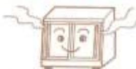
これは加湿バットからの水蒸気ではなく食材から発生する蒸気によるものです。この様な場合には引き違いガラス戸を少し開いて(15~20mm程度両側)庫内より蒸気をにがして使用されるようお願いします。(蒸気の発生が収まりましたら引き違い戸を閉めて保温してください。) そのままで使用されると本器ケースの外に水滴が流れ出したり、漏電や感電等のトラブルの原因となりますので充分ご注意ください。
