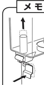
フォーセットレバーを押すと、フォーセットノズルが上がり、容器内の飲料が出てくる仕組みです。
