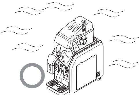
本機の電源は、専用の漏電遮断器付サーキットブレーカーもしくは、それと同等の設備のある専用コンセントを使用してください。
