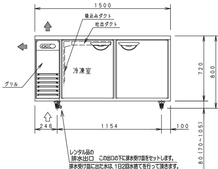
レンタル品の排水出口 この出口の下に排水受け皿をセットします。排水受け皿に出た水は、1日2回水捨てを行って頂きます。
